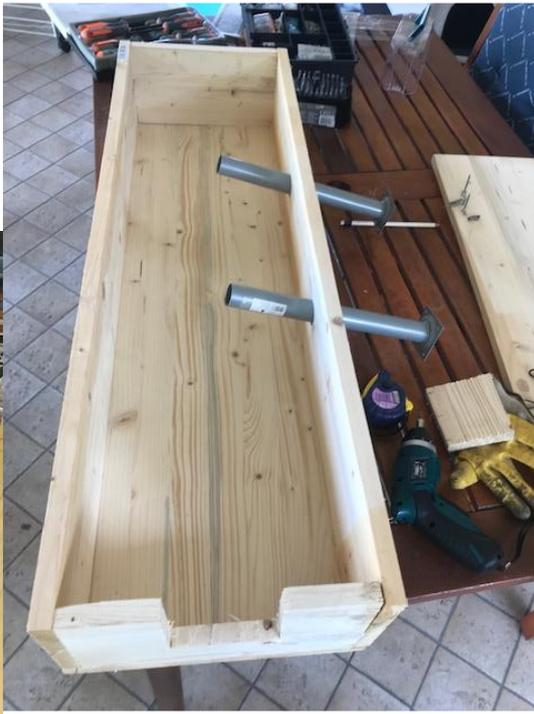
Nell'ultima immagine si può vedere il prodotto finito con i tubi per permettere il passaggio dell'aria e in fondo il buco per infilarvi il metallo da scaldare (non puntavamo a fonderlo ma solo a scaldarlo molto per rendere più facile martellarlo e dargli la forma)
